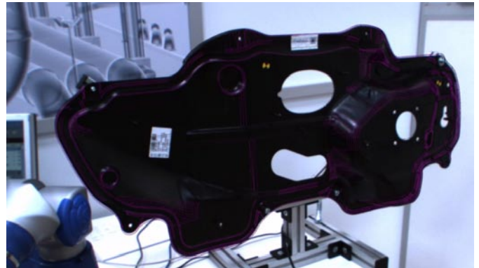
Realität und digitale Daten vermischen sich: Real ist die Spritzschutzwanne zwischen Fahrgastzelle und Motorraum...
