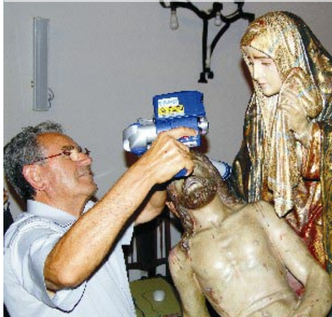
Numérisation d'une statue avec le ScanArm
